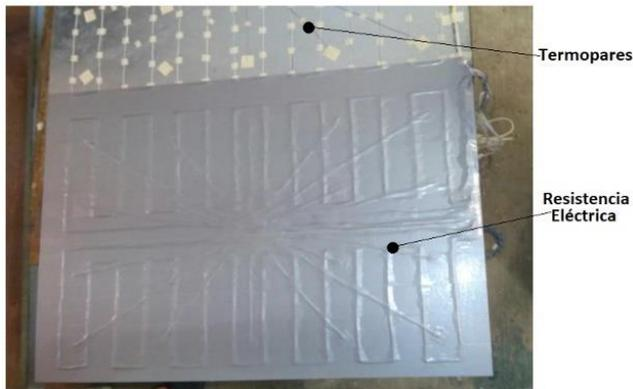
Figura 2. Instrumentación de la placa absorbadora.
