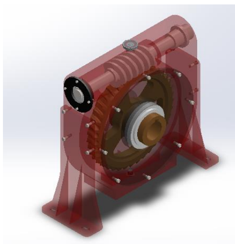
Figura 1 Reductor de tornillo sinfín diseñado en SolidWorks.
